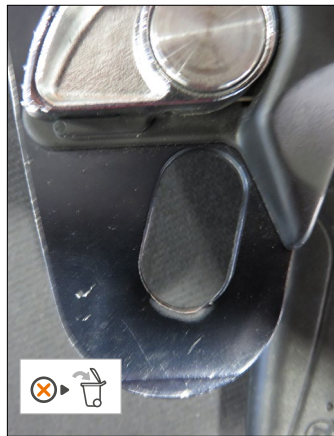
• Trou de connexion déformé suite à un choc
