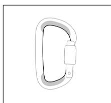
• Vérifiez l'usure provoquée par le passage de la corde ou l'appui sur les ancrages (profondeur des marques : une usure de plus d'un mm de profondeur est grave, apparition d'arêtes tranchantes...).
