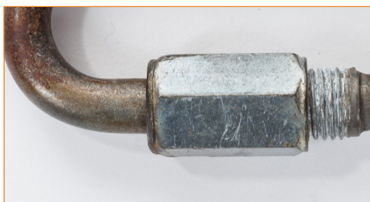
Maillon rapide présentant des traces d'oxydation et une bague de verrouillage qui ne se visse pas facilement.
