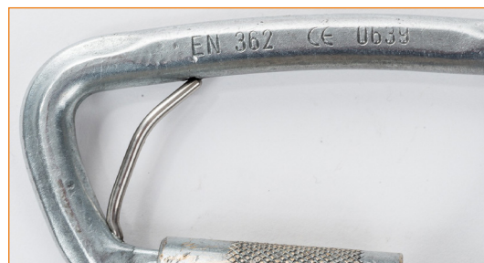
Connecteur avec barrette déformée
