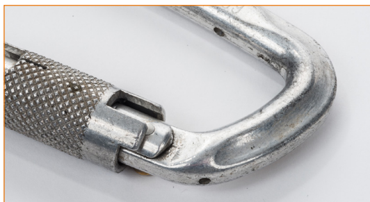
Connecteur avec barrette manquante.
