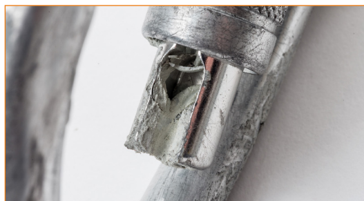
Connecteur avec dépôt de résidus à l'intérieur de ses cavités et de ses interstices. ⚠ Nettoyer le connecteur avec de l'air comprimé, de l'eau et du savon.
