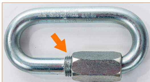
Maillon rapide avec bague de verrouillage vissée au-delà de la limite possible.
