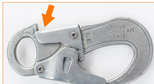
Connecteur à double gâchette avec gâchette de sécurité postérieure qui ne revient pas en position automatiquement.
