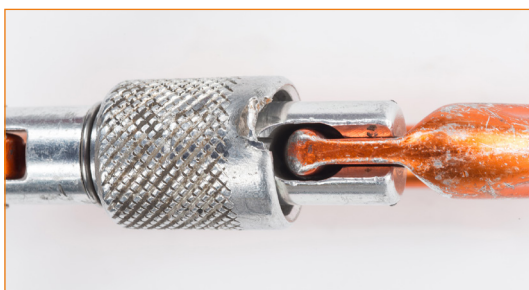
Connecteur avec bague de verrouillage à vis fortement détériorée.
