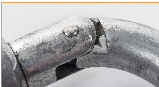
Connecteur avec rivet usé.
